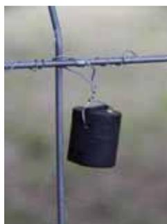
Foto 119. Sensor de temperatura instalado en la valla del laboratorio de cría de náyades. 14/5/13.
