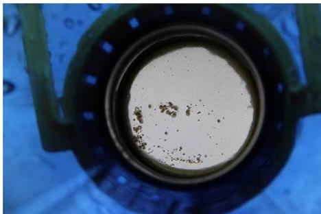
Foto 186. Proceso de revisión de los tuppers, que incluye el filtrado, renovación de agua y conteo en lupa.
