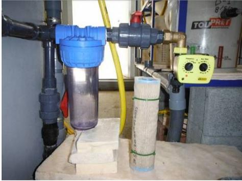
Foto122. Sistema filtrado de plancton del agua que entra del lago antes que entre en los cilindrocónicos y evitar el taponamiento de los filtros de recogida de juveniles de náyade. 2/1/14.
