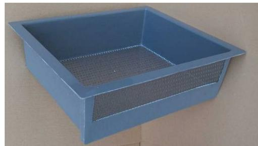
Foto 129. Bandeja de la pila de incubación que permite una circulación del agua de abajo para arriba.
