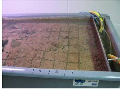
Foto 137. Imagen de la Pila de incubación con la siembra de 2012, se aprecian la casillas identificativas y el sistema de renovación de agua doble, con autocirculación y aportes periódicos de agua del lago para la renovación del sistema.
