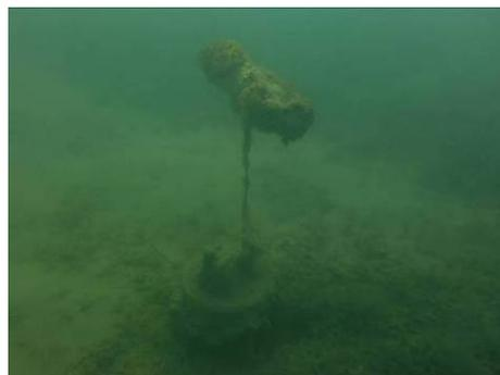
Foto 121. Sensor de temperatura instalado en el fondo del lago de Banyoles. 23/10/12.
