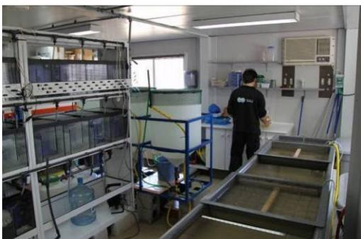
Foto 83. Interior del laboratorio de cría de náyades con la pila de incubación con juveniles de náyades, la batería de acuarios de peces y los cilindrocónicos. 8/3/12.
