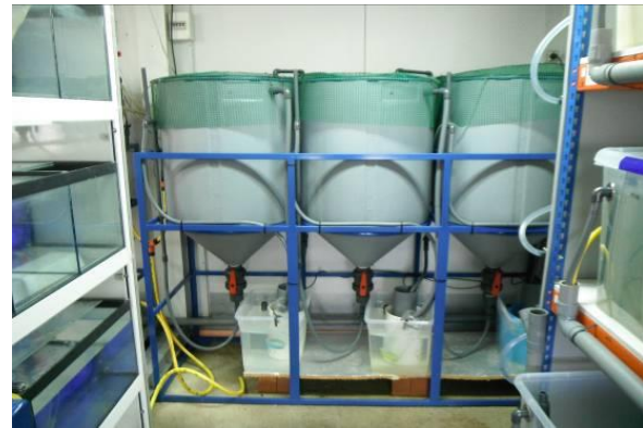
D - Tancs cilindre-cònics per la residència dels peixos infectats i per la recollida de juvenils
