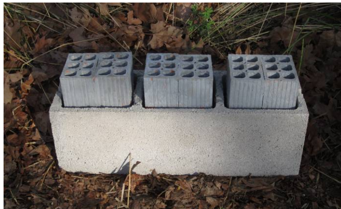
Tipo I – Bloques de hormigón y ladrillos
