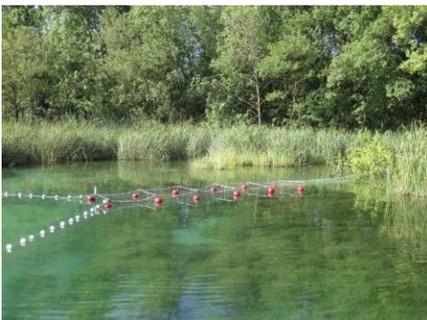
Se han fabricado unos modelos de grandes trampas constituidas por un cuerpo abierto por la parte superior (10 m de longitud) y unas alas de 15 a 20 m. El cuerpo se ha diseñado abierto para permitir que se puedan escapar los animales cabeceadores. Han resultado de muy baja eficacia para los peces.
