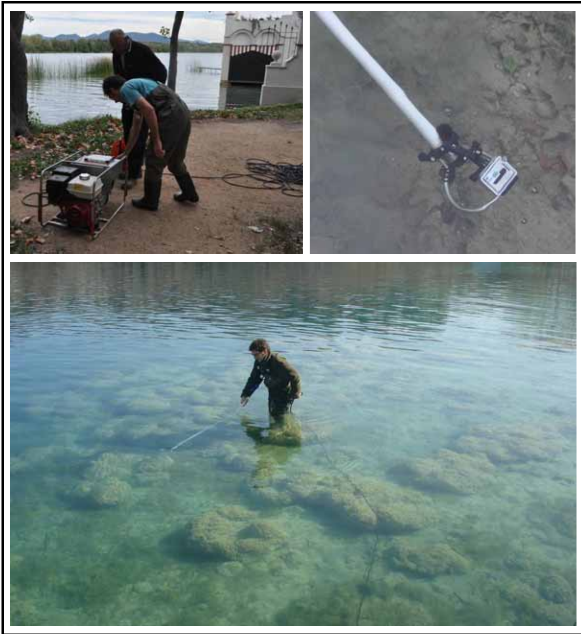
Figura 10.- Imatges del mostreig de seguiment específicament destinat a la població de bavosa de riu ( Salaria fluviatilis ) de l'Estany de Banyoles: a dalt a l'esquerra, aparell de pesca elèctrica; a dalt a la dreta, detall de l'ànode sense xarxa, durant una prova d'adaptació d'una càmera subaquàtica; a baix, operació de pesca en una zona de travertins. Fotos: Consorci de l'Estany.
