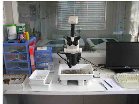
Microscopi estereoscòpic adquirit per al laboratori de nàiades i també utilitzat per a la classificació i fotografia dels macroinvertebrats.
