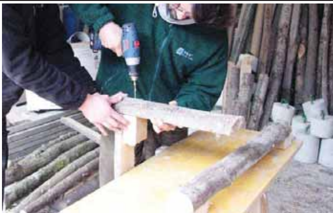
Muntatge del marc de fusta de castanyer, amb trossos de fusta tractada als extrems. Al fons piles de fusta de castanyer i altres.
