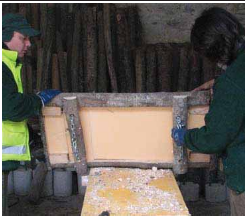
Unió de la part superior amb la inferior amb unes cadenes. Reforç de la part inferior amb un tros més de fusta de castanyer.
